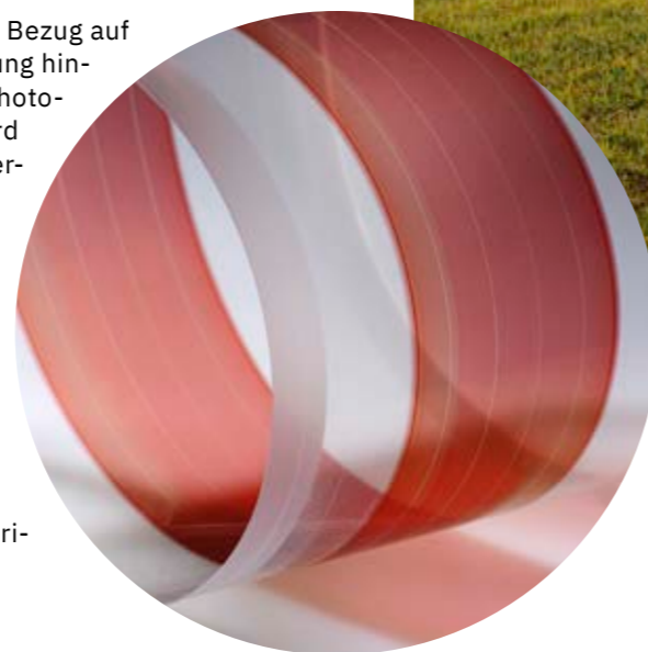
Abb. 1: Produktionsmuster eines biegsamen Photovoltaikmaterials
