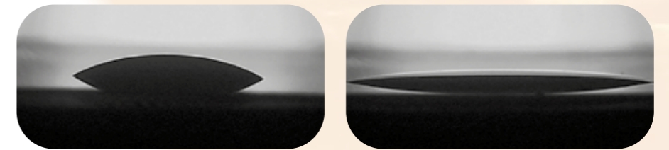
Abb. 6: Lichtmikroskopische Aufnahmen eines Tropfens PEDOT:PSS-Dispersion auf der photoaktiven Schicht P3HT:PCBM, links: ohne Vorbehandlung, rechts: nach Excimer-Behandlung
