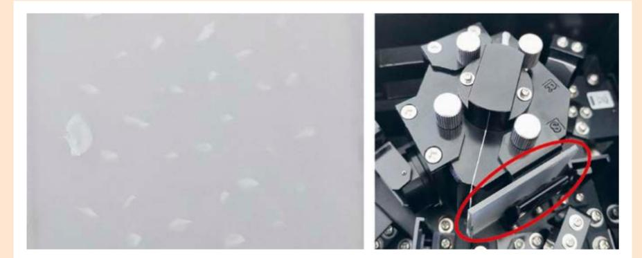
Abbildung 2: PMMA-Platte nach COLIPA vor dem Verreiben der Sonnencreme (links) und bereit für die Messung an der Integrationskugel montiert (rechts).
