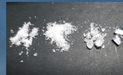
Abbildung 3: Siebfraktionen eines Polycarbonats von links nach rechts zu sehen sind: 500-, 1.500-, 3.000-µm-Partikelfraktionen und 5 mm Granulate
