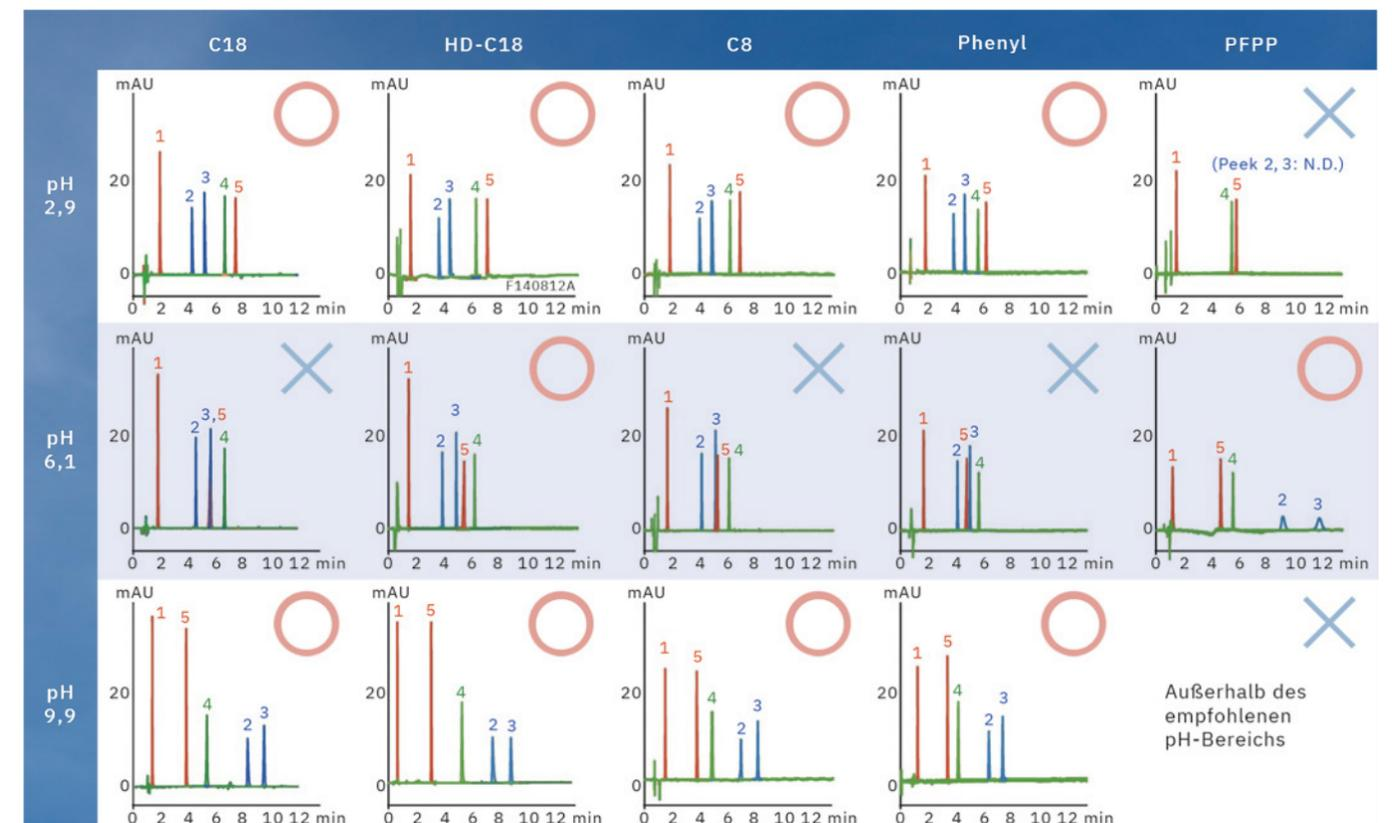
Abbildung 4: Die Shim-pack Scepter-Säulen bieten eine hohe Stabilität, auch unter niedrigen sowie hohen pH-Werten. Peaks: 1: Saccharin (pKa = 2,2), 2: Dextrometorphan (pKa = 8,3), 3: Amitriptylin (pKa = 9,4), 4: n-Butylparaben (pKa = 8,3), 5: Ibuprofen (pKa = 4,4).
