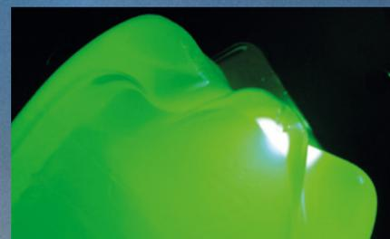
Abbildung 2: PET-Flaschenboden (koffeinhaltige Limonade) und die Fluoreszenz unter einer Xenon-Lichtquelle. Die Flasche wurde dazu in den Probenraum des RF-6000 montiert.
