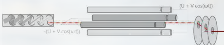
Abbildung 2: Schematischer Aufbau eines Quadrupol-Massenfilters und eines nachgeschalteten Multielektronenvervielfachers als Detektor
