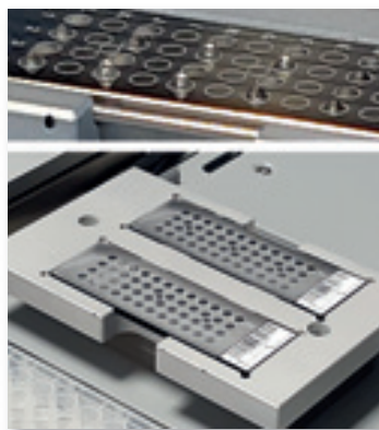
Abbildung 2: Spezifische Unterstützung für das Fleximass-Target
