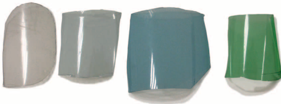
Abbildung 2: Kunststoffzuschnitte aus PET-Flaschen
