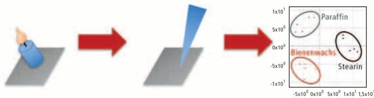
Abbildung 1: Workflow: Wachs direkt von der Kerze auf die geätzte Oberfläche auftragen → Analyse mit dem Massenspektrometer → Übereinstimmung in der statistischen Software
