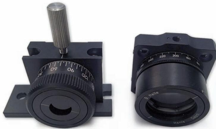
Abbildung 4: Polarisator (links) und Depolarisator (rechts). Die Linie auf der Halterung des Polarisators gibt die transmittierte Polarisationsrichtung an.
