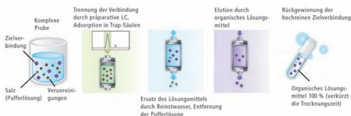
Abbildung 2: Prominence UFPLC™-Fraktionierungs-, Konzentrierungs-, Reinigungs- und Eluierungsarbeitsablauf
