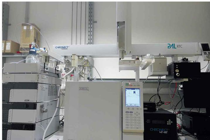
Abbildung 1: Das LC-GC-FID-Online-System mit GC-2010 Plus, LC-20ADXR, SPD-20A und CBM-20A LITE
