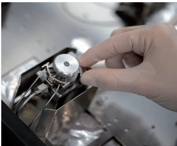
Abbildung 3a und 3b: Wartung ohne Werkzeug am Beispiel des Liner-Wechsels beim Splitinjektor (SPL) oder Säuleneinbau im GC-Ofen. Das optionale Ofenlicht unterstützt diesen Schritt durch gute Ausleuchtung und einwandfreie Sicht auf die möglichen Säuleneinschlüsse.
