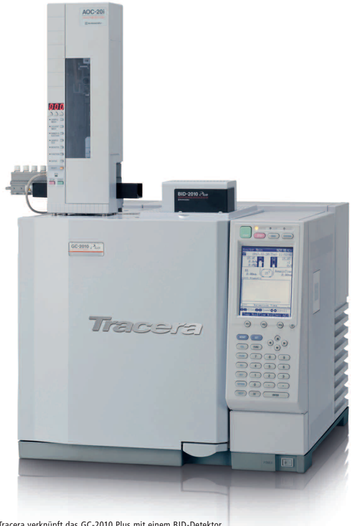
Tracera verknüpft das GC-2010 Plus mit einem BID-Detektor
