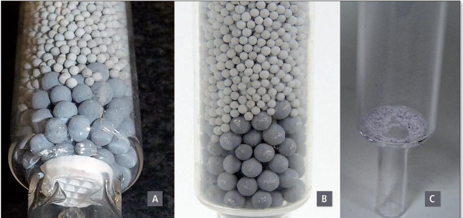
Abbildung 1: Bei 680 °C kristallisieren die Salze aus und rieseln durch das Verbrennungsrohr in die Salzfalle (Bild 1c). Die Abbildung zeigt den Katalysator vor der Messung und nach der Messung einer ca. 9%igen Salzlösung (600 Injektionen).
