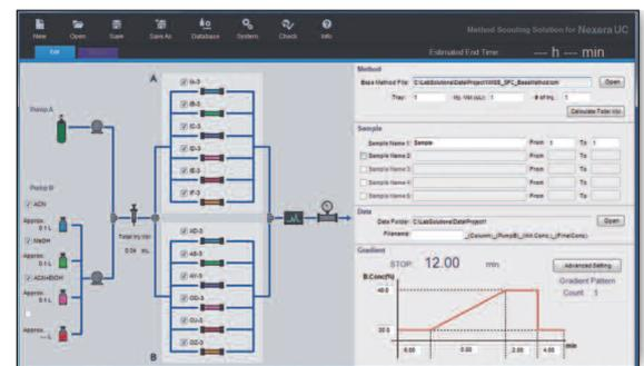
Abbildung 2: GUI der Method Scouting Solution für die Nexera UC
