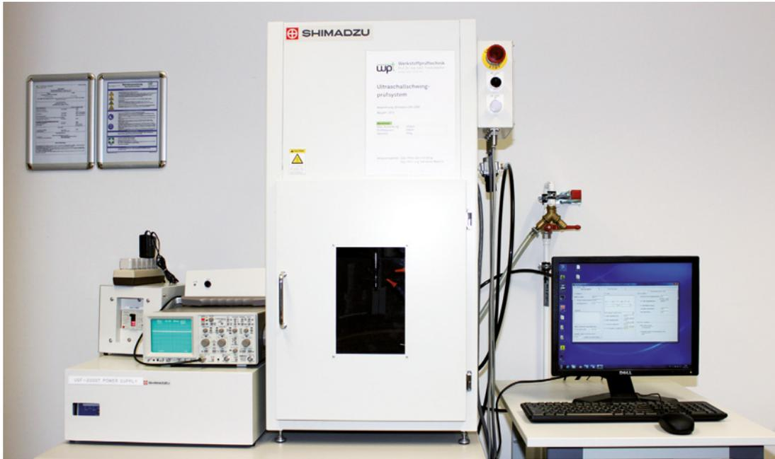
Abbildung 1: Ultraschall-Ermüdungsprüfsystem USF-2000 von Shimadzu
