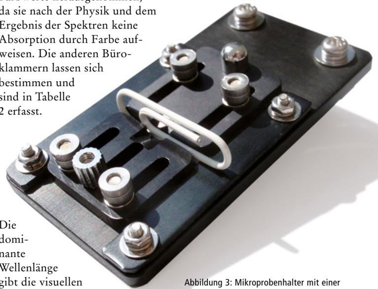
Abbildung 3: Mikroprobenhalter mit einer eingespannten weißen Büroklammer
