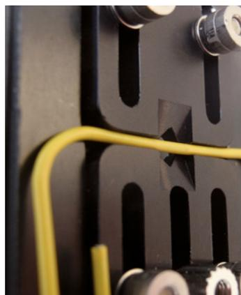
Abbildung 2: Detailaufnahme einer eingespannten gelben Büroklammer mit Sicht auf das 3 x 3 mm Messfenster
