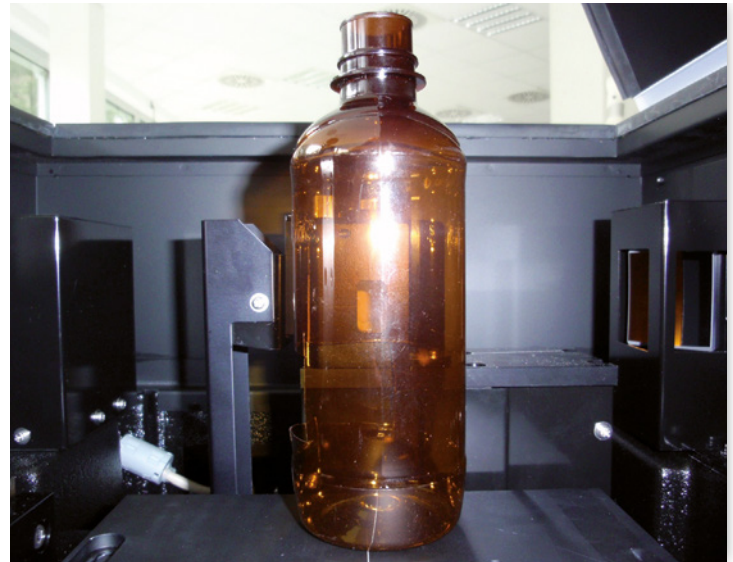
Abbildung 2: Flasche in Messposition vor einer Integrationskugel im MPC-2600, das Messfenster beträgt 1 x 2,5 cm. Die Flasche kann mit dem x-y-z Tisch positioniert und das Messfenster kann durch diese dünnwandige transparente Flasche gesehen werden.
