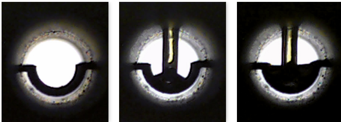
Abbildung 1: Die Abbildungen zeigen ein Grafitrohr im Strahlengang, vor und während der Injektion (insgesamt 25 µl). Wichtig ist, dass die Probe sorgfältig und reproduzierbar „abgelegt“ wird.
