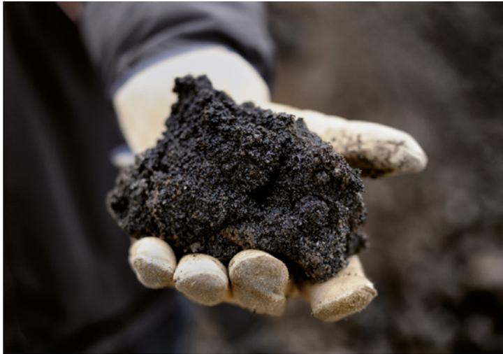
**B**itumen wird in vielen Alltagsprodukten verwendet – etwa in Teppichböden oder Dachpappen. Am bekanntesten ist Bitumen durch den Straßenbau; im Asphalt wird es mit anorganischen Zuschlagstoffen vermischt.
