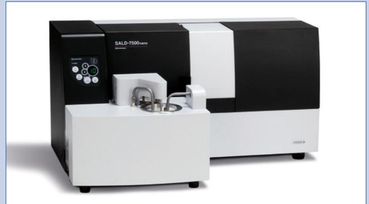
Speziell für die hochempfindliche Messung von Partikeln im Submikro- und Nanometerbereich wurde die 7er-Serie entwickelt. Das erfolgreiche SALD-7101 wird nun vom neuen SALD-7500 abgelöst.
