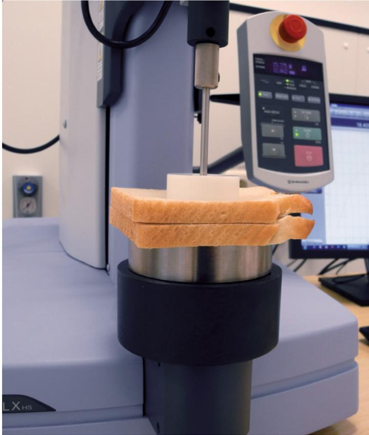
Abbildung 1: Texture Analyzer EZ-Test-LX mit ø 50 mm Kompressionsaufsatz
