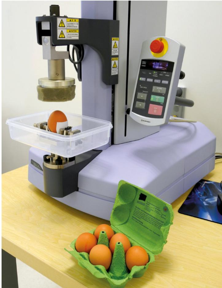
Abbildung 1: Texture Analyzer EZ-Test LX mit modifiziertem Kompressionsaufsatz
