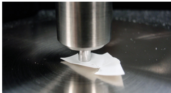
Abbildung1: Der Stempel der Anpresseinheit des DuraSamplers drückt ein Zerfallsstück der Plastiktüte gegen das Diamantfenster
