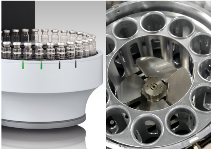
Abbildung 3: Umluftgeheizter Inkubatorofen und Probenhalter des HS-20
