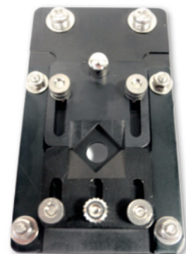
Abbildung 1: Mikroprobenhalter für Proben von 10-14 mm im Durchmesser oder in Rechteckform; das Lichtbündel zur Messung in Transmission ist maximal 5 mm im Durchmesser
