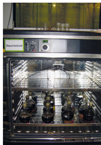
Abbildung 1: Versuchsaufbau zur Biogasherstellung im Labor
