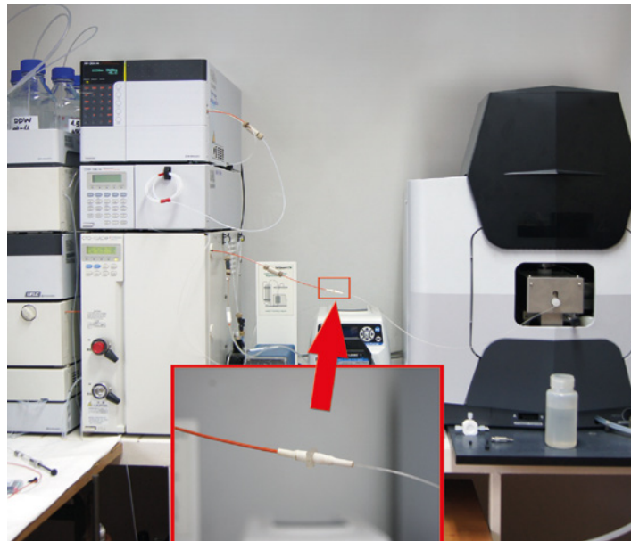
Abbildung 1: HPLC-FAAS Analysesystem, das im Labor der Abteilung für Wasser und Bodenanalyse der Chemischen Fakultät der Adam-Mickiewicz-Universität in Posen (Polen) eingesetzt wird.
