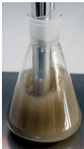
Abbildung 3: Die Suspension wird dispergiert
