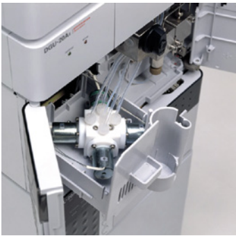
Abbildung 1: Nexera Pumpe mit installiertem quarternären Gradientenventil
