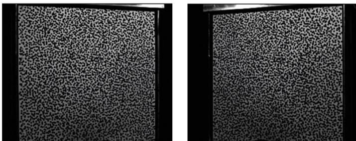
Abbildung 2: Ein Original-Bildpaar der beiden HPV-2-Kameras, das das Speckle-Muster auf der Aluminiumprobe zeigt
