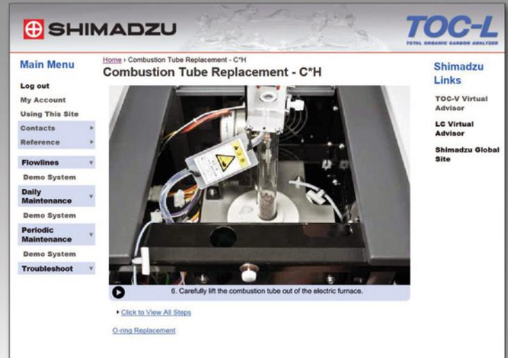
Abbildung 4: Animation zum Wechsel des Katalysatorrohrs
