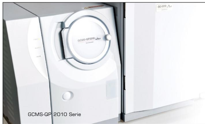
Die Fokussierung des Detektors auf die exakte Masse des TCDD von  $m = 321,894$  u bei einer Peakhalbwertbreite  $w_{1/2} = 0,03$  u blendet Matrixkomponenten mit weniger Chloratomen oder komplett chlorfreie Moleküle aus, selbst wenn diese eine ähnliche Masse von zum Beispiel  $m = 322,23$  u besitzen. Insbesondere diese hohe Spezifität, die mit einer Massenauflösung von  $R \approx 10000$  (zu R siehe Abb. 2) erzielt wird, macht die HRMS unverzichtbar in komplexen Matrices.
