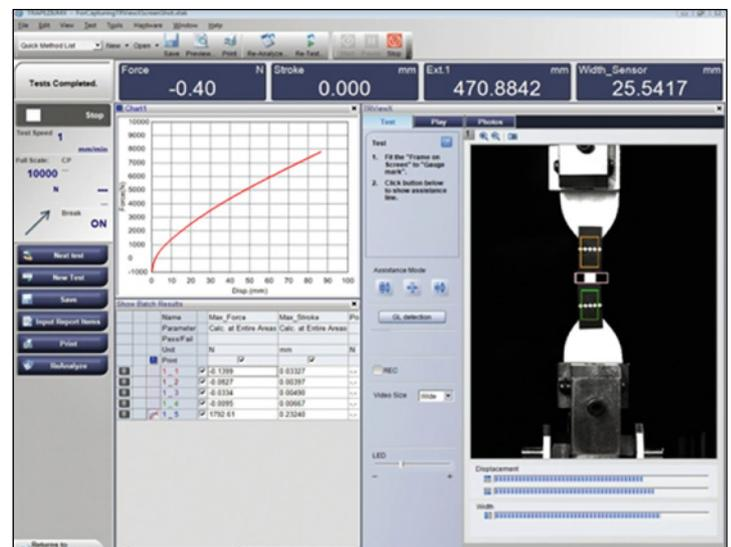
Abbildung 2: Kraft-Dehnungs-Diagramm mit eingebundener Videoaufzeichnung
