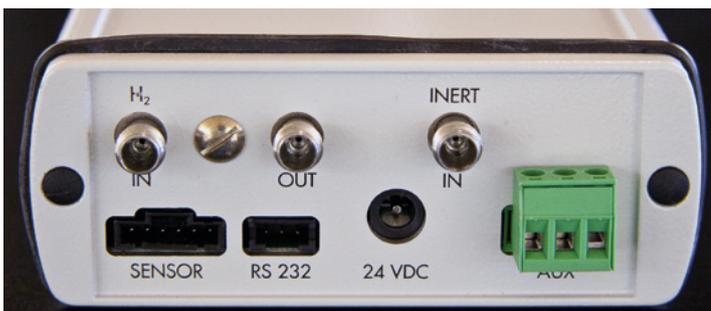
Abb. 3: Rückansicht der Kontrolleinheit des Wasserstoffsensors mit Gasanschlüssen
