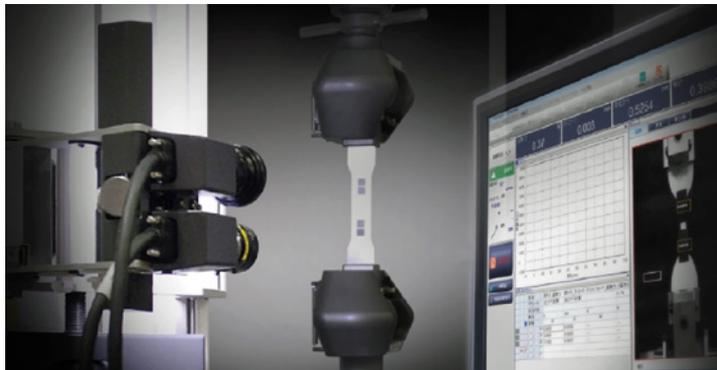
Abbildung 1: Shimadzu Videoextensometer TRViewX mit Doppelkamera für große Messbereiche
