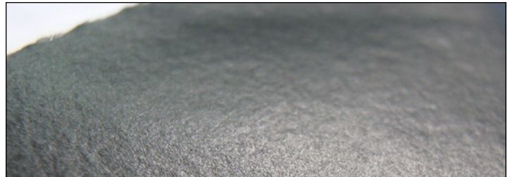
Abbildung 2: Oberfläche des schwarz gefärbten Folienteils, ein raues und festes Polymer. Es stammt vom Rand der Einlage wie in Abbildung 1 gezeigt.
