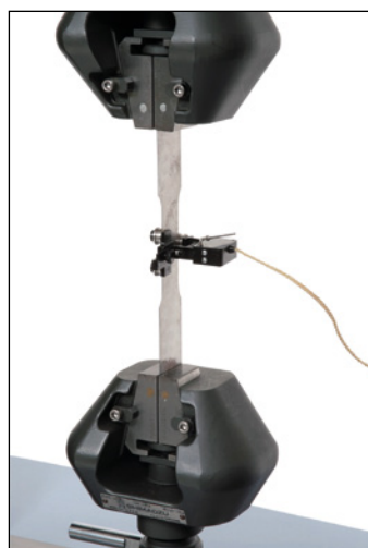
Abbildung 3: Typischer Versuchsaufbau: Stahlzugprobe nach DIN 50125 mit manuellem Keilspannzeug und handaufgesetztem Dehnungsaufnehmer
