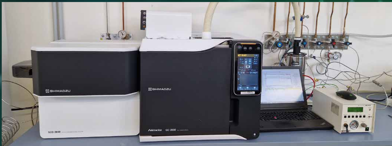
Abbildung 1: Nexis GC-2030 ausgestattet mit einem Detektor SCD-2030, einer Ventilbox LVO-2030 und einer MicroJet-Kryofalle
