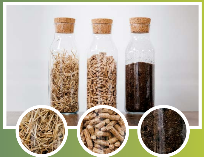
Abbildung 2: Stroh, Holzpellets und Kompost – drei der biogenen Rohstoffe, die das Team von Wild Hydrogen für die Wasserstoffherzeugung untersucht hat
