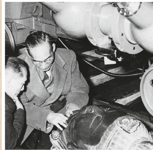
▲ Ein Shimadzu Röntgensystem gewährte 1953 Einblicke in den Kopf einer beschädigten Statue aus dem Yakushiji-Tempel in der Stadt Nara
