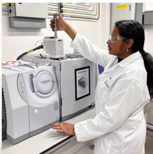
Abbildung 3: Anitta Xavier (Studentin im Forschungspraktikum) injiziert eine Biomasseprobe in ein Mikropyrolysegerät von Frontier Lab zur direkten Übertragung an das GCMS-QP2010 SE System
