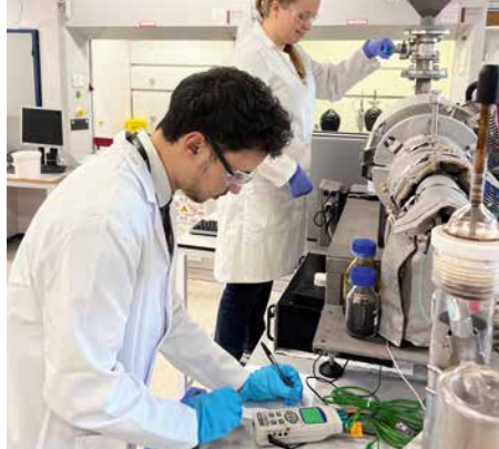
Abbildung 1: Adam Elaradi (Studentischer wissenschaftlicher Mitarbeiter) und Dr. Sarah Asplin (Postdoktorale wissenschaftliche Mitarbeiterin) betreiben das Zwischenpyrolysesystem für den Laborbereich am EBRI. Das System fasst bis zu 300 g/h Biomasse und weist eine maximale Verarbeitungstemperatur von 600 °C auf.
