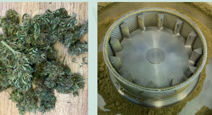
Abbildung 8: Cannabisblüten vor der Vermahlung und nach der kryogenen Vermahlung in einer Kugelmühle (insgesamt 4 min für 20 g Probe) oder der ZM 300 (10 min für 500 g Probe)
