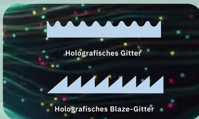
Abbildung 3: Rillenform eines Beugungsgitters
