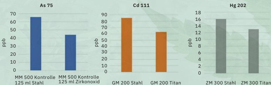
Abbildung 12: Effekte des korrekten Mahlwerkzeuges auf Analyseergebnisse. Der Abrieb aus Stahlwerkzeugen führt zu erhöhten Schwermetallwerten und verfälscht somit die Analyse.
