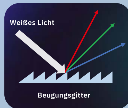
Abbildung 2: Prinzipien von Prismen und Beugungsgittern
