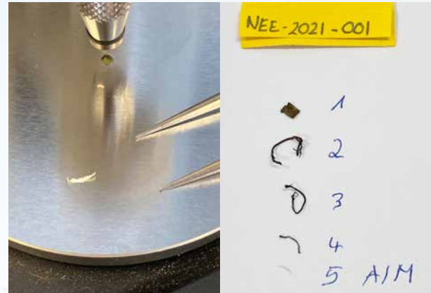
Abbildung 4: Probe NEE-2021-001 Nummer 5 zum Größenvergleich auf dem Messplatz einer QATR-S. Das runde Diamantfenster ist kleiner als 2 mm im Durchmesser (links). Die Probe stammt aus einem Vogel-magen aus Nordostengland (rechts).
