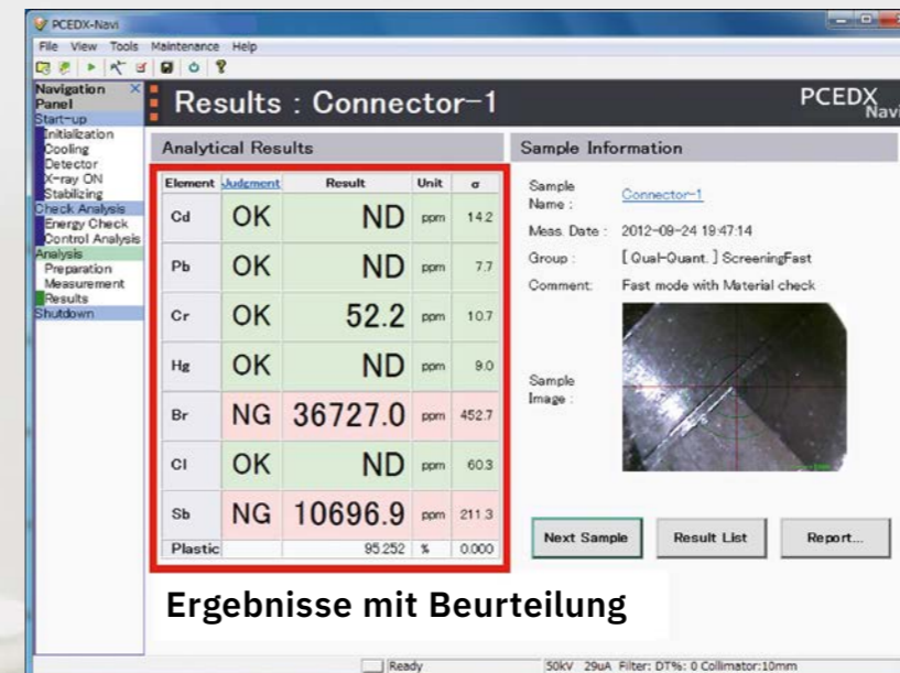
Abbildung 4: Beurteilung einer Probe mit hinterlegten Qualitätskriterien (hier RoHS-Grenzwerte)
